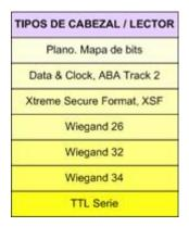
El dispositivo iACD admite la utilización de uno o dos cabezales lectores simultáneamente. Los cabezales se utilizan para identificar a las personas y/o vehículos utilizando tecnologías muy diversas. Lo más importante a la hora de conectar los cabezales es tener en cuenta la tecnología de comunicación con el dispositivo electrónico. En la figura de la derecha se muestran algunos de los tipos los tipos admitidos.
