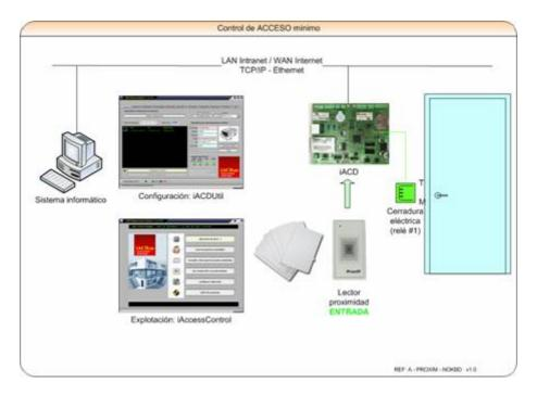
En la imagen de la derecha puede ver un ejemplo de un sistemas de control de acceso con el mínimo de componentes posibles.
